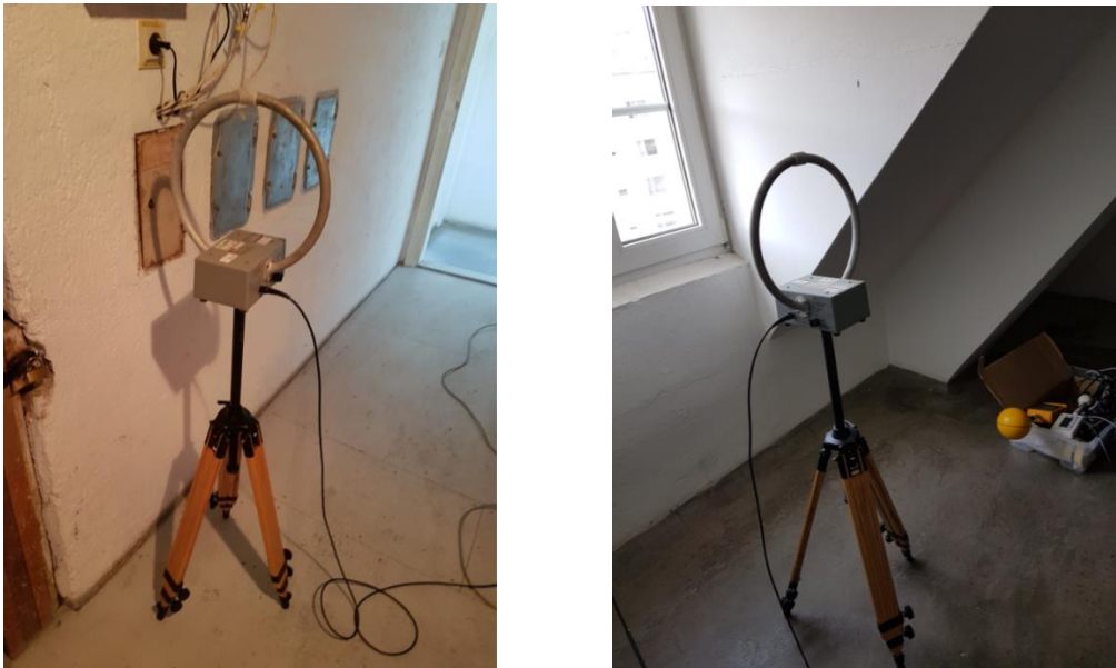
Abbildung 2.12: Messpunkte M6 im Flur vor einem Verteilerkasten (links) und M7 in einem Nebenraum (rechts) im Dachgeschoß
