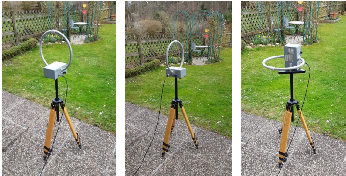
Abbildung 2.2: Verwendete Shielded Active Loop 6507 in den drei separat gemessenen orthogonalen Ausrichtungen zur Erfassung des Gesamtvektors der magnetischen Flussdichte.
